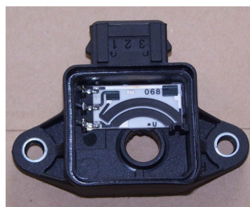
汽车节气门传感器 Throttle position sensor of automobile
